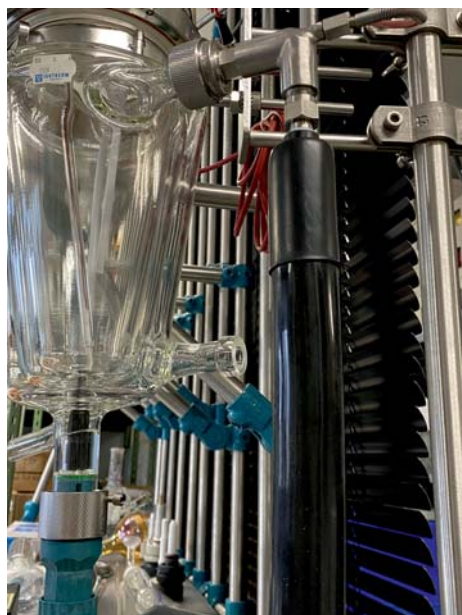
- mit glattem, schwarzen Silikon-schlauch, NW12, M16x1IG
