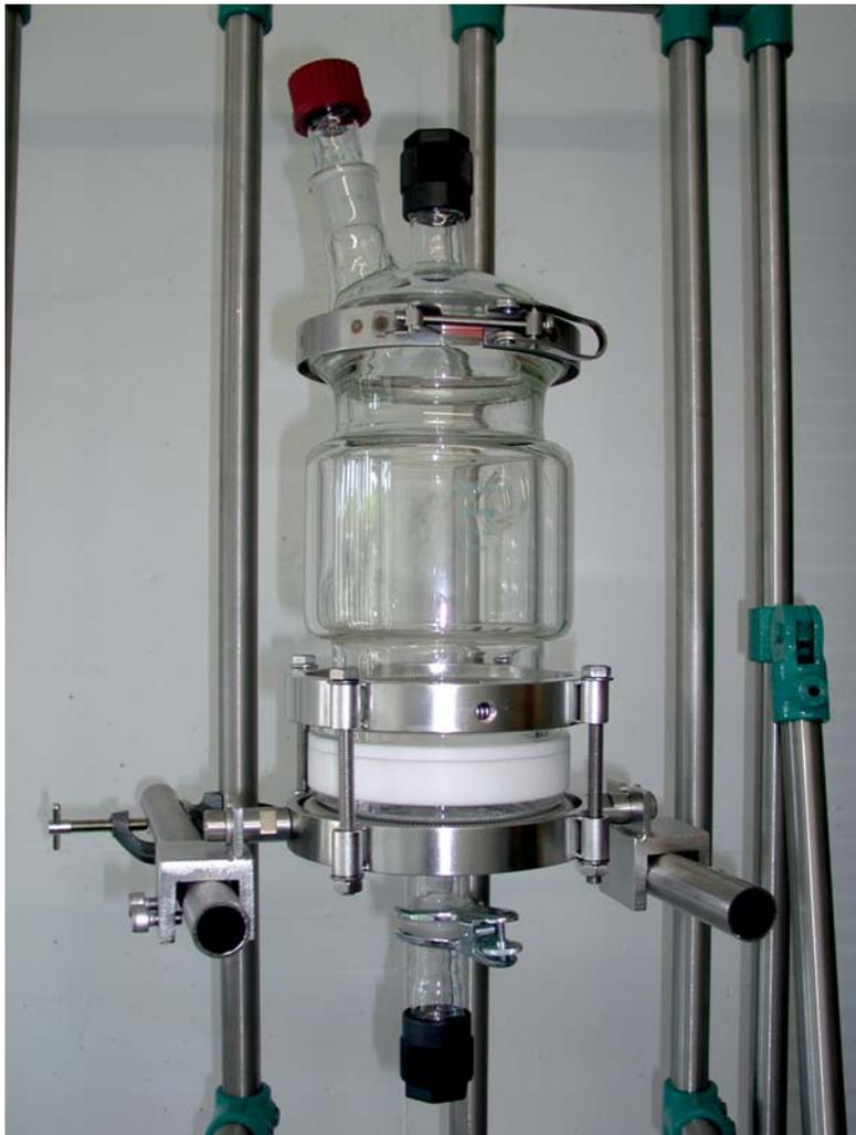
**AMSI-Filtereinheit DN 100 aus Boro 3.3, Mittelstück zylindrischer Teil heizbar, bestehend aus:**
